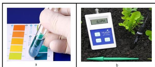
Fig -2: Measurement process of PH in (a) water (¿Qué es el pH? ph en el agua y en el cuerpo - Alkanatur | Expertos en Agua Alcalina Antioxidante) and (b) soil (Cómo funcionan los medidores de pH, y su importancia en los cultivos - Como Funciona Que)
